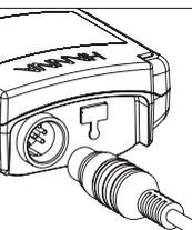
10. Connectez la sonde **HI764113** à l'instrument **HI98198**.
