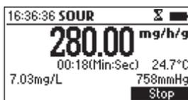
A la fin de l'analyse, l'appareil affiche la valeur SOUR calculée, la durée de la mesure et les valeurs de pression et de température. Appuyez sur **Enr.** pour enregistrer cette analyse.
