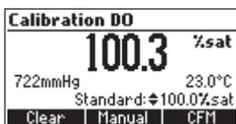
Lorsque la lecture est stable et proche du standard choisi, la touche fonctionnelle *CFM* est affichée. Appuyez sur **CFM** pour confirmer le point d'étalonnage. L'instrument revient à l'écran de mesure et la sonde enregistre les données d'étalonnage.
