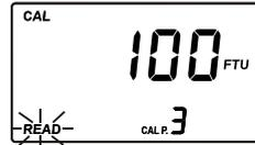
**Note :** À ce moment, il est possible de quitter l'étalonnage en appuyant sur CAL/RCL. L'instrument mémorisera les données d'étalonnage en deux points (<0,1 et 15,0 FTU) et reviendra en mode mesure.
