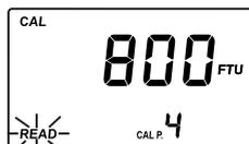
**Note :** À ce moment, il est possible de quitter l'étalonnage en appuyant sur CAL/RCL. L'instrument mémorisera les données d'étalonnage en trois points (<0,1; 15,0 FTU et 100 FTU) et reviendra en mode mesure.
