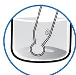
**Pourquoi ?** - Pour une mesure correcte, la membrane et la jonction de référence doivent être immergées dans l'échantillon.
