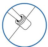
**Pourquoi ?** - L'électrolyte de référence assure le pont électrolytique, son écoulement vers l'extérieur de l'électrode est de règle. En cas de niveaux d'électrolyte trop bas, les mesures sont erronées (ne concerne pas les électrodes à remplissage gel et solide).
