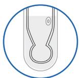
**Pourquoi ?** - Avec l'eau distillée, la concentration des ions KCl s'appauvrit dans l'électrolyte, entraînant l'anéantissement de la conductibilité électrolyte du système.
