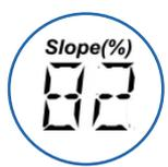
**Pourquoi ?** - Au fil du temps, la membrane en verre sensible s'altère occasionnant des mesures erronées. Une détérioration liée à l'usage peut aussi en être une cause.
