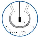
**Pourquoi ?** - À l'usage, certains échantillons produisent des dépôts sur le bulbe. Ces dépôts altèrent le bon fonctionnement de la jonction liquide et faussent les mesures et étalonnages.
