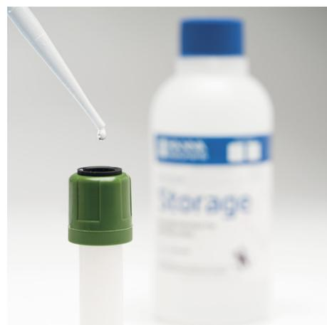
Stocker l'électrode à la verticale et mettre toujours quelques gouttes de solution de conservation **HI70300L** dans le bouchon de protection.
